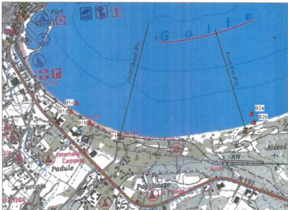
Fig. 53 : schéma d'implantation du site de Calvi.
