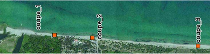
**Coupe 1 :** La largeur de la plage est moyenne. Elle présente peu de relief avec une berme en pente douce, et pas de dune en arrière plage. En revanche, de constructions occupe le haut du cordon littoral avec des implantations de grillages et/ou de murets de protection. Des indices d'érosion chronique sont remarquables au niveau des habitations, avec des pertes de matériel au niveau des fondations.
